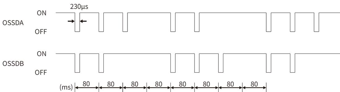
※连接至 OSSD 的设备，如安全继电器或接触器等，不应对这些暂时的、自我诊断的关闭信号作出反应。
