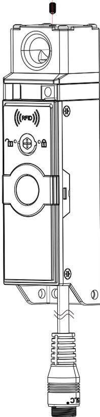
如果安装后，门打开、关闭不顺畅，也可拆卸左图的锁定机米螺钉（对边1.5mm）然后再行使用。由于此种情况下门极易被打开，请根据需求另行准备门吸产品。
