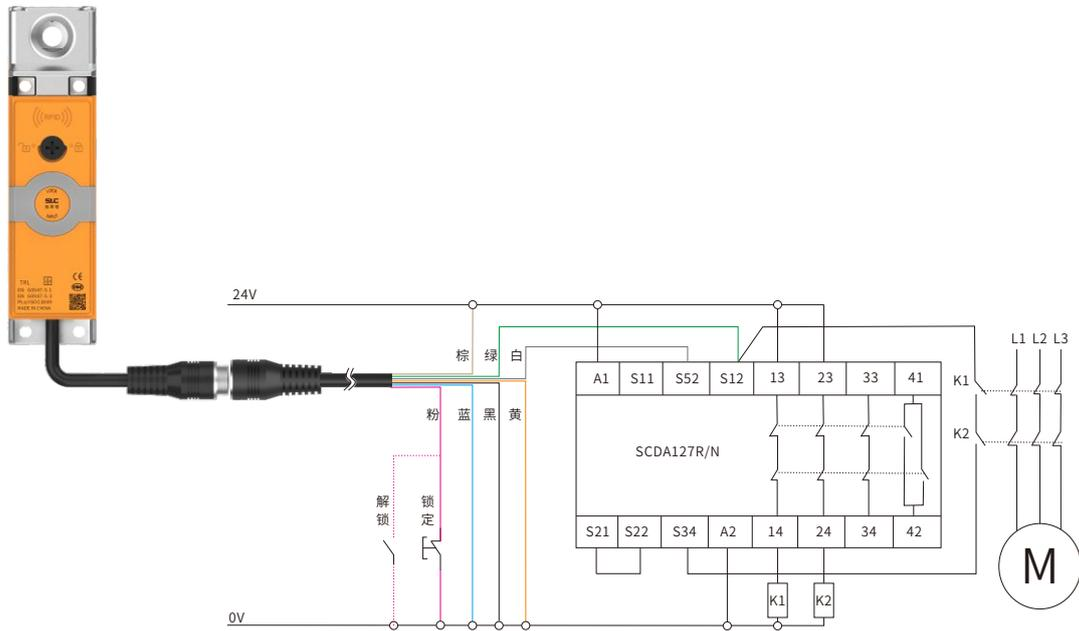
机械锁定PNP型安全门锁与SCDA127R应用接线实例
