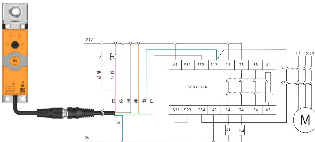
电磁锁定NPN型安全门锁与SCDA127R/N应用接线实例
