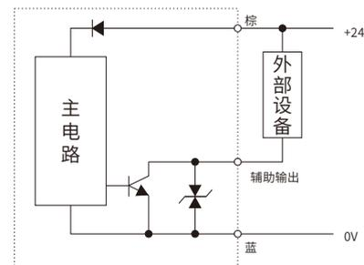
电磁锁定PNP型安全门锁与SCDA127R应用接线实例
