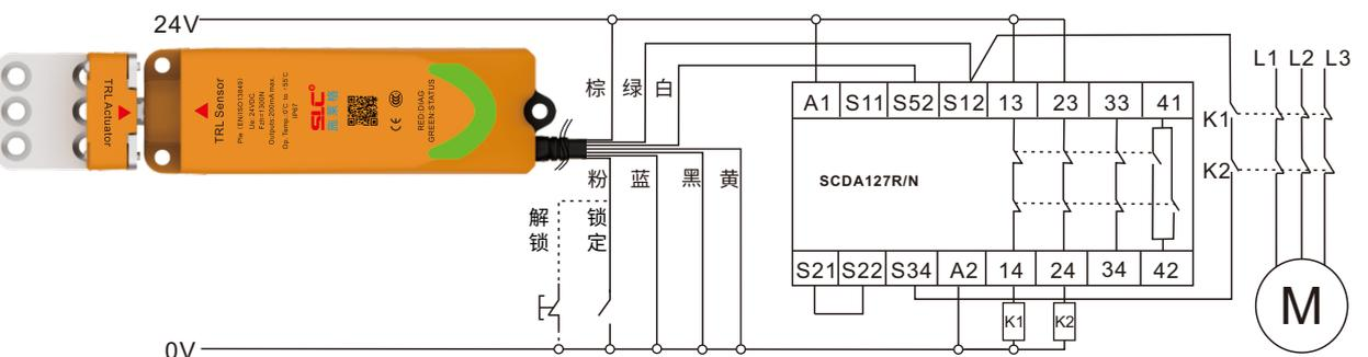
TRL2系列(PNP)上电锁定型安全门锁多锁级联与安全模块接线图
