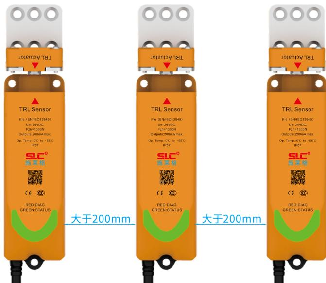
使用多个TRL2安全门锁时，可能出现相互干扰而导致TRL2安全门锁发生误动作。为防止相互干扰，请按如下规定安装TRL2安全门锁。
