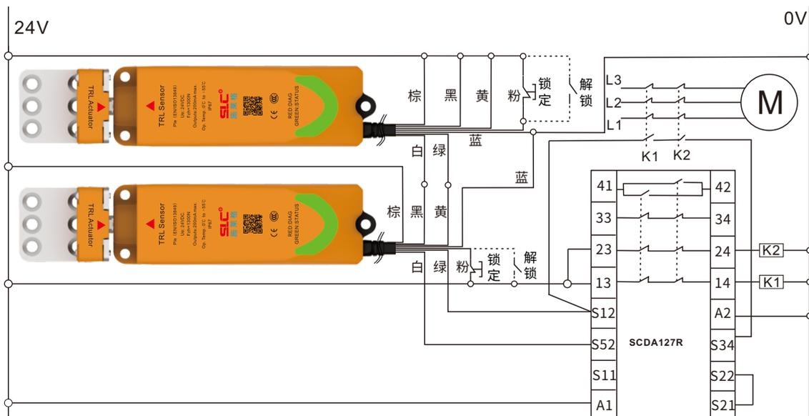
TRL2系列(PNP)上电释放型安全门锁多锁级联与安全模块接线图
