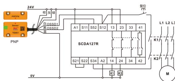
TEM01系列RFID开关双路级联NPN型输出级联接线示例
