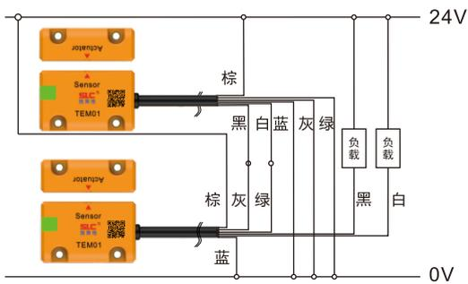
TEM01系列RFID开关双路级联PNP型输出级联接线示例
