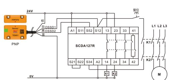
TEM01系列RFID开关双路级联NPN型输出应用接线示例
