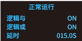
产品上电自诊断出故障或者正常运行中检测到故障,OLED会显示”运行故障”,此时需要根据LED的指示来分析故障类型。
